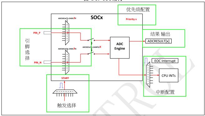
SPC1068 的 ADC 是一个差分(differential)转换器,每一个 SOC 有两个差分 Sample and Hold,分别为 S/H A 与 S/H B,而每一个 Sampler 内又有正端(P)与负端讯号(N)的区别,注意 S/H A 与 S/H B 若同时 enable,则自动转为同步采样模式,详见同步采样范例,用户可根据上图挑选想要的通道进行转换,其中一端接上 GND 即是常见的单端输入 ADC。
