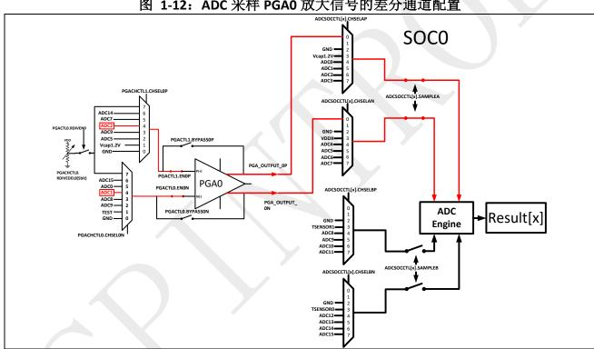
图 1-12: ADC 采样 PGA0 放大信号的差分通道配置
